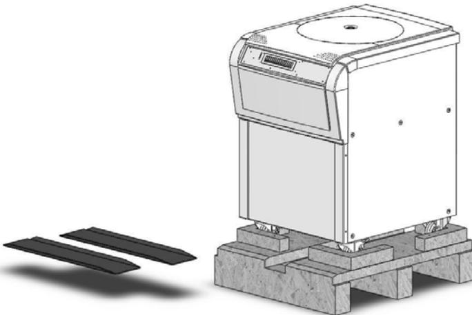
3. Fije los carriles de rodadura con tornillos delante del aparato sobre el palet.
