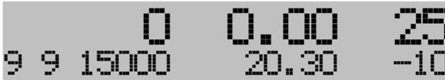
La fila superior indica el tiempo y el régimen de revoluciones. Están a 0. La indicación de temperatura muestra el valor actual en el recipiente del rotor. La fila inferior muestra los valores de la última marcha.
