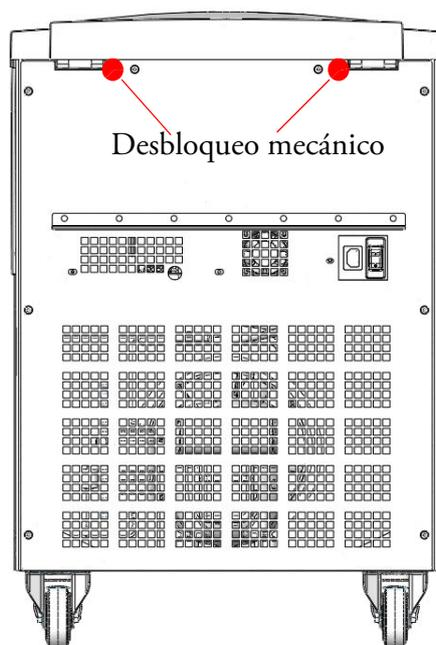
**Figura 7-1.** Desbloqueo mecánico
