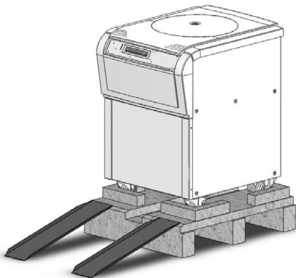
4. Retire el ángulo del palet que fija la centrifuga sobre el palet. Suelte los frenos de rodillo. Ruede la centrifuga del palet con varias personas.
